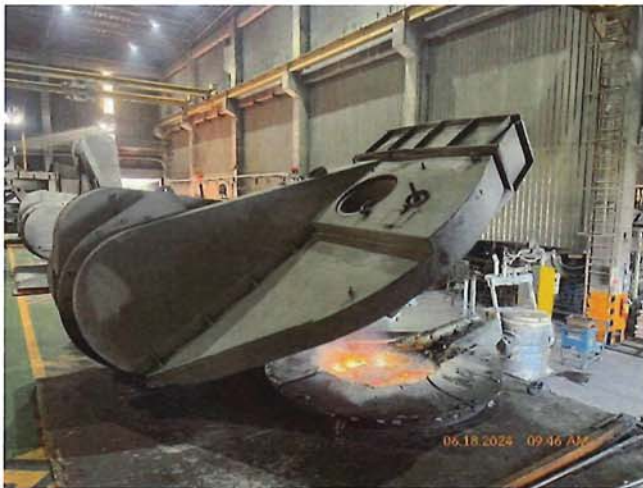
ภาพที่ 7 ระบบรวบรวมฝุ่น (ขั้นตอนเติมแมกนีเซียม)
